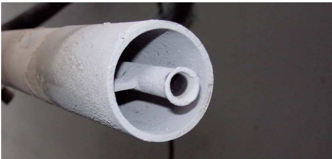
Abb.16 Kombidampfzange für die kombinierte Dampf- und Reagenzeindüsung
